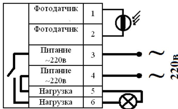
Рис. 2. Схема сборки фотодатчика.
