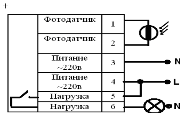
Рис. 2. Схема сборки фотодатчика.
