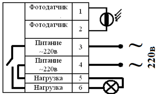
Рис. 2. Схема сборки фотодатчика.
