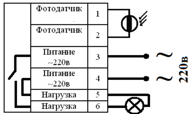
Рис. 2.Схема сборки фотодатчика.
