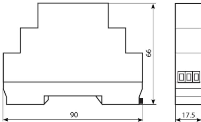
Рис. 1. Корпус фотореле.
