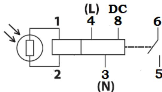
Рис.4. Схема фотореле. Для питания реле 12-24в AC/DC задействовать контакты 4 и 8 (опционально).
