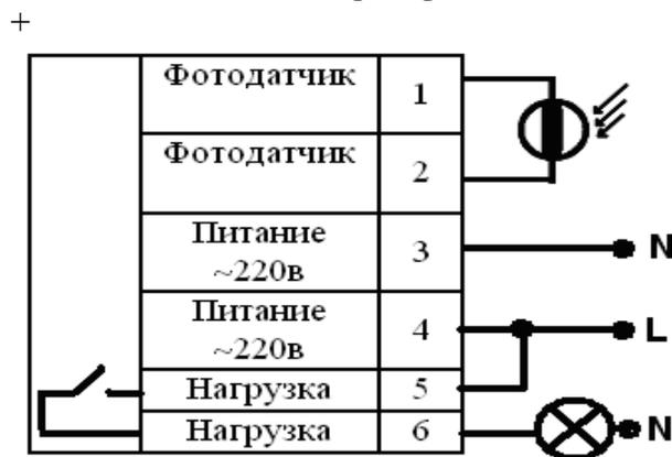
Рис.3. Типовая схема подключения фотореле к сети 220в.
