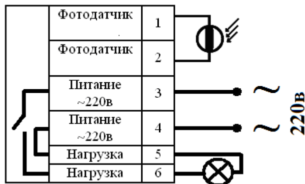
Рис. 3. Типовая схема подключения фотореле к сети 220в.
