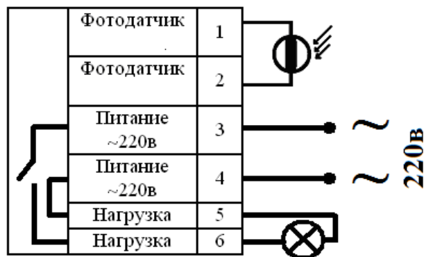
Рис. 2. Схема сборки фотодатчика.
