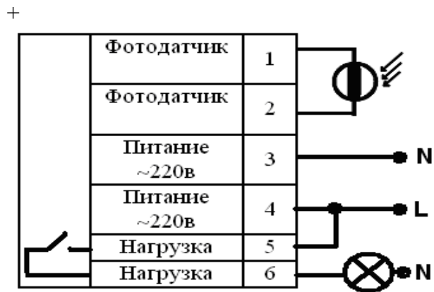
Рис.3. Типовая схема подключения фотореле к сети 220в.
