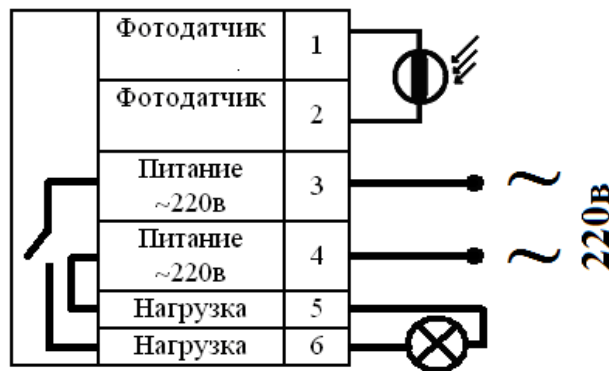
Рис. 3. Типовая схема подключения фотореле к сети 220в.
