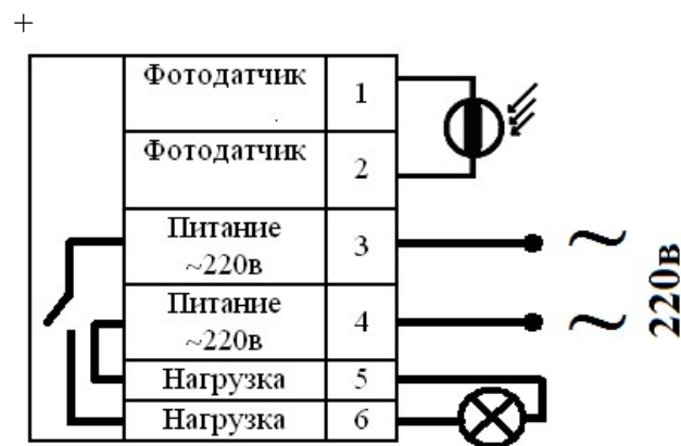
Рис. 3. Типовая схема подключения фотореле к сети 220в.
