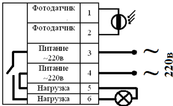
Рис. 2. Схема сборки фотодатчика.
