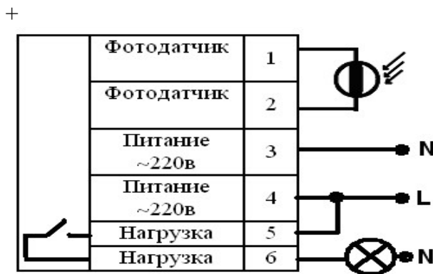
Рис. 2. Схема сборки фотодатчика.
