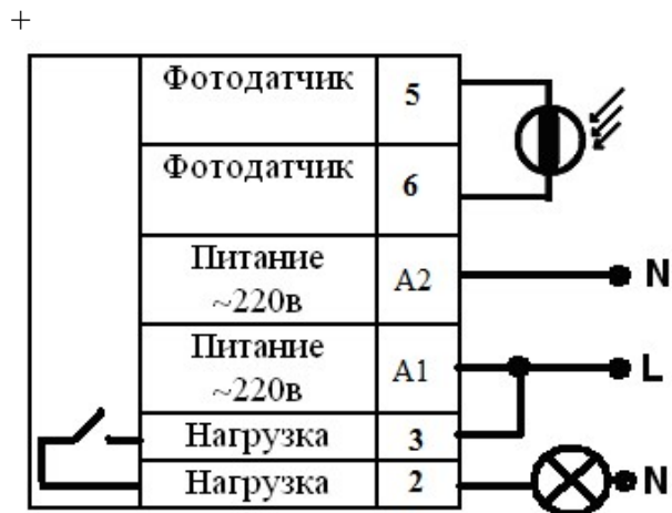
Рис.3. Типовая схема подключения фотореле к сети 220в.
