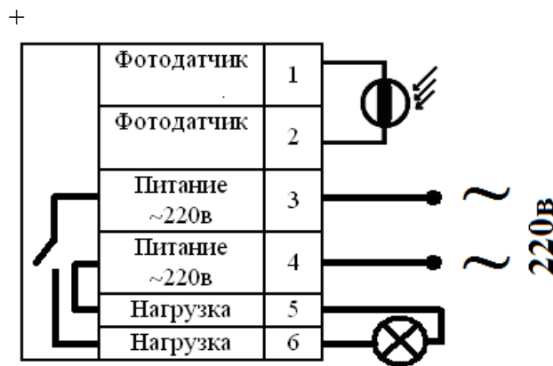
Рис. 3. Типовая схема подключения фотореле к сети 220в.
