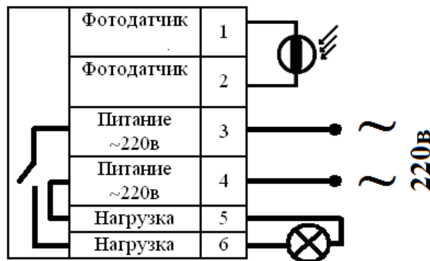
Рис. 2. Схема сборки фотодатчика.
