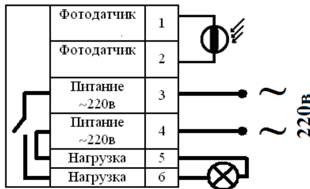
Рис. 2. Схема сборки фотодатчика.
